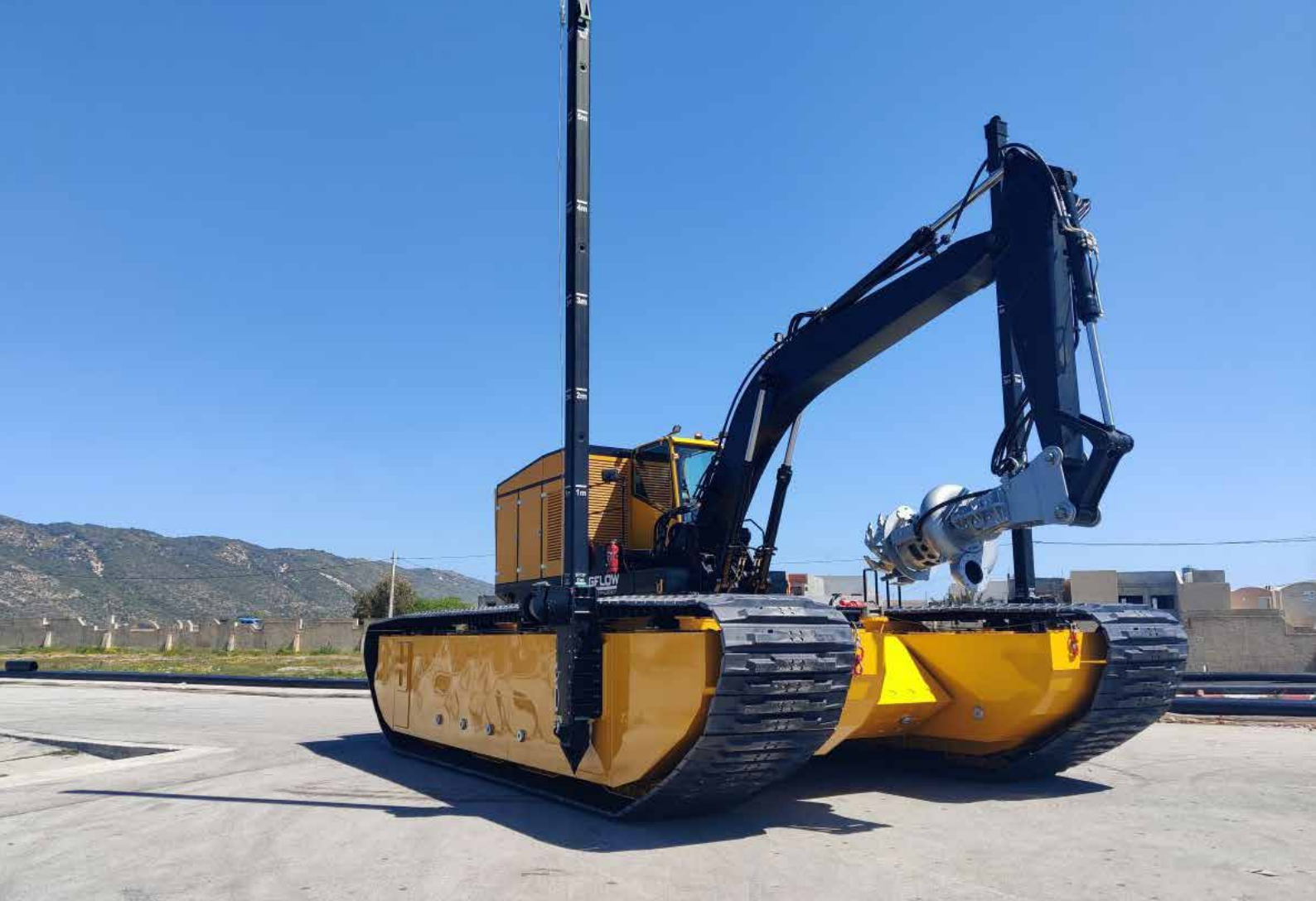
Kraftvoller Vorstoß in neue Dimensionen: Tsurumi erweitert mit Dragflow sein technisches Lösungsspektrum für herausfordernde Projekte - hier ein amphibischer DRM-Bagger mit Hochleistungspumpe am Ausleger (Foto: Dragflow).
